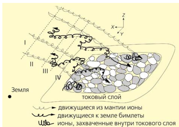
Рис.12. Сценарий генерации бимлетов в токовом слое хвоста магнитосферы Земли. С точки зрения процессов превращения энергии, токовый слой не однороден, а состоит из перемежающихся областей повышенного рассеяния ионов (заштрихованные овалы) и областей импульсного ускорения плазмы (белые овалы). Причем деление на эти области не стационарно, картина все время меняется — то в одной, то в другой части токового слоя вспыхивают новые или распадаются старые области импульсного ускорения бимлетов. Римскими цифрами показаны области магнитосферы: I — мантия; II — высокоширотная часть хвоста; III — пограничная область плазменного слоя; IV — плазменный слой.
